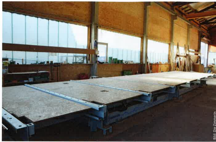
Den Montagetisch hat bereits Katharinas Vater angeschafft, um Holzrahmenbauelemente präzise fertigen zu können.
