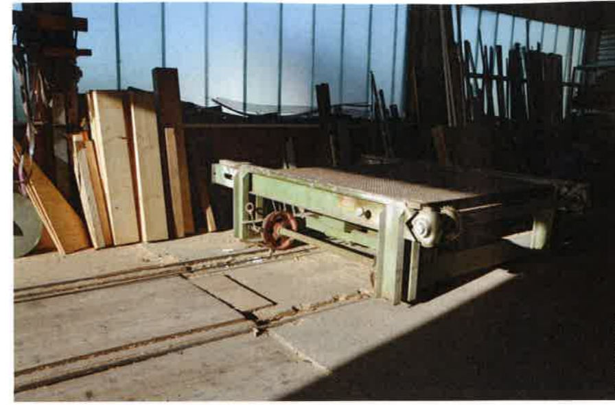
Von Halle zu Halle transportiert ein Querförderer, der noch aus den Zeiten stammt, als der Zimmerei ein Sägewerk angegliedert war.
